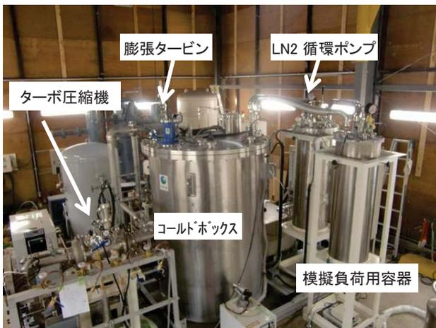
・冷却システムのステップ応答 (0.2kW→1.5kW加熱) で、良好な動作を確認
