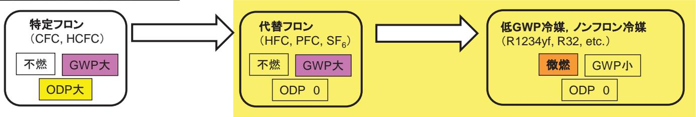
低GWP冷媒の導入のためには、燃焼性、毒性等の基礎的データを収集し、これをベースにしたリスクアセスメントが必要
