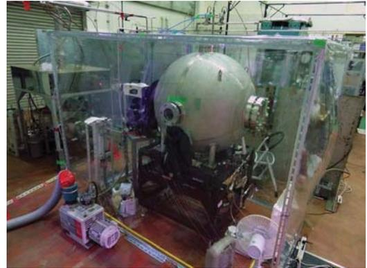
密閉式爆発反応容器を用いた燃焼試験装置
