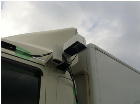
図 III.2.2.(1)-5 白線認識装置拡大図
