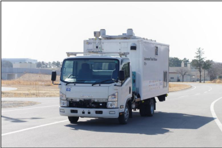
図Ⅲ.2.2.(8)-2 省エネ運転制御実験車外観
