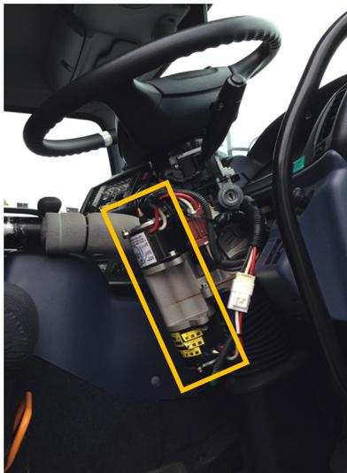
図Ⅲ.2.2.(1)-7 操舵モータ搭載状態
