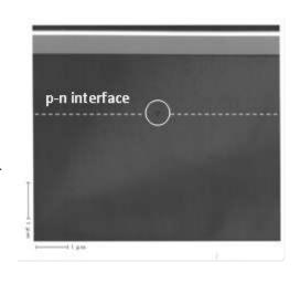
図 3 - 4 4 エピ成長時に pn 接合 界面に取り込まれた異物
