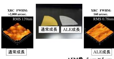
AFM像 5 μm×5 μm
