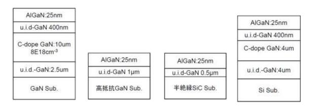
図3-79 各種基板のエピタキシャル構造
