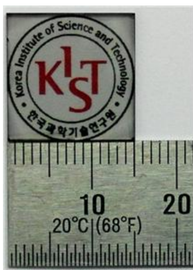
＜図 3＞透明なカーボンナノシート(15mm)
