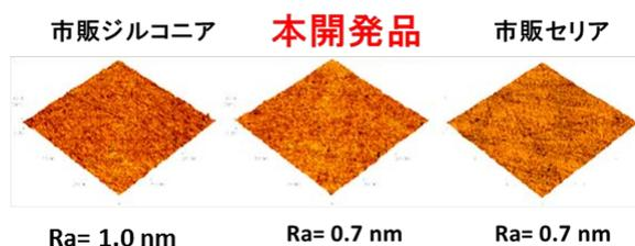
図⑦-1-9 既存及び開発研磨材を用いて研磨したガラスの表面粗さ比較
