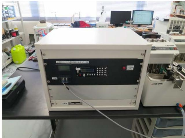
図Ⅲ(4.5)-1 実験用高周波電源プロトタイプ
