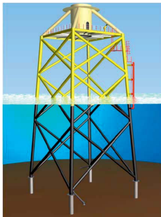
⑨ ジャケット設置完了 (グラウト工完了)
