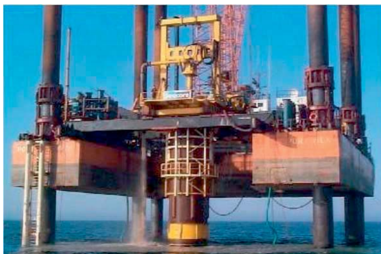
図 3.7.2-8 掘削機の外観
