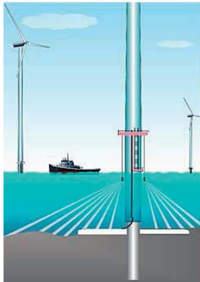
図 3.2.5-7 2軸スキャンソナーシステムの概要
