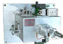
高効率蓄熱放熱システムの開発(高効率バーナー)
