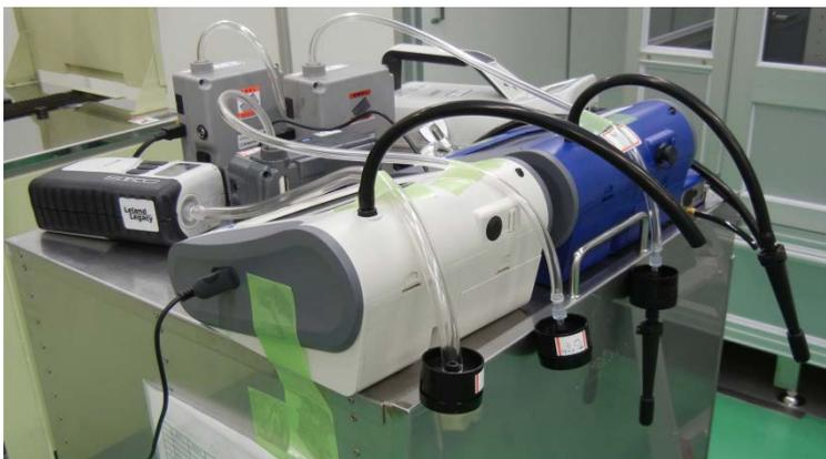
計測器によるモニタリング及びフィルターへの粒子捕集の様子
