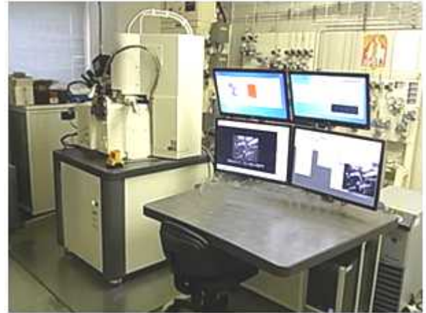
図Ⅲ-2.1.2-7 開発されたその場装置の外観 (制御部)
