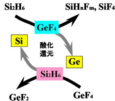
図 21. GeF<sub>4</sub>-Si<sub>2</sub>H<sub>6</sub> 系の反応
