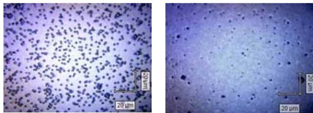
図 20. SiO<sub>2</sub> 基板上にバッファ層無 (左) 有 (右) で反応性 CVD 成長した Si<sub>0.5</sub>Ge<sub>0.5</sub> 膜のエッチング後顕微鏡写真
