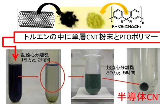
図 26. 半導体 CNT の抽出工程
