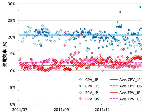
図 44. 日米発電効率比較 (集光型および非集光型)
