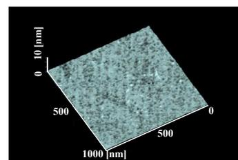
図 25. ピコステップガラスの AFM 像
