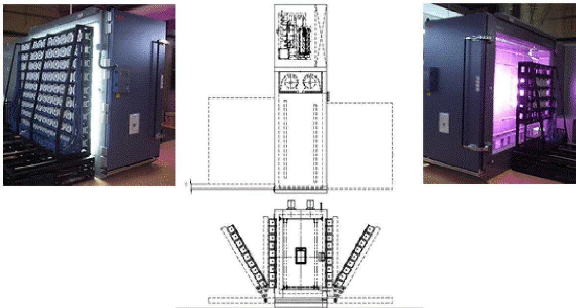
図 51. LED 式光照射試験装置
