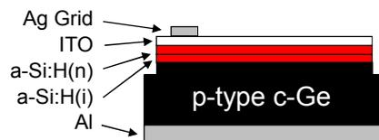
図 14. 作製したデバイス構造
