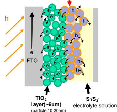
図 32. コア/シェル構造 Si 量子ドット増感型太陽電池の構造
