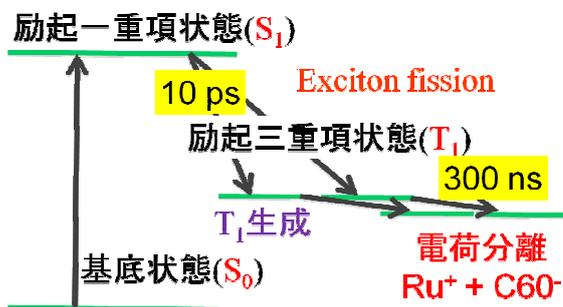
図 23. ルブレン単結晶での Fission 過程
