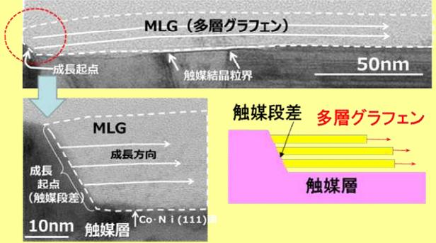
2. 低温成長MLG高品質化によるドーピング実現(フェルミレベルシフト)
