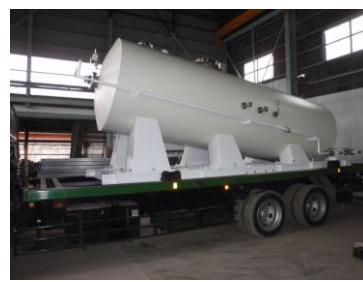
写真：メタン吸蔵容器 (容器容量:10m 3 、メタン吸蔵量:500m 3 N)
