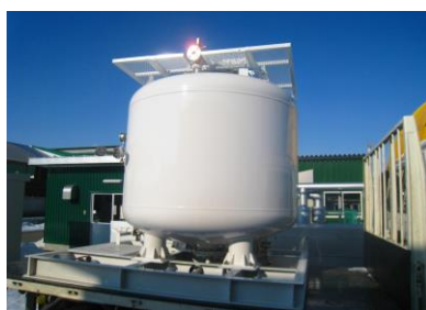
写真：メタン吸蔵容器 (容器容量:4m 3 、メタン吸蔵量:200m 3 N)
