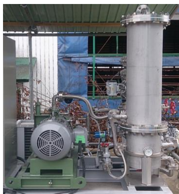
写真：超小型1塔式PSAバイオガス精製装置 (供給量200m 3 N/日、メタン回収率95%)
