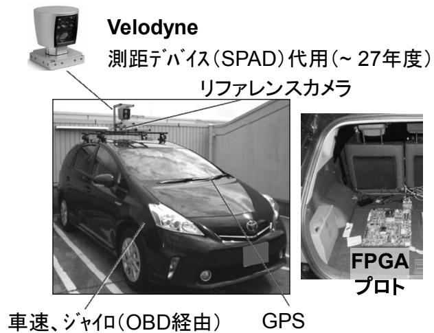
図III. 2. 1. 1-9 FPGA プロトと実車評価環境
