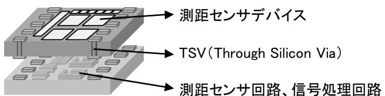
図III. 2.1.1-1 三次元実装受光 IC
