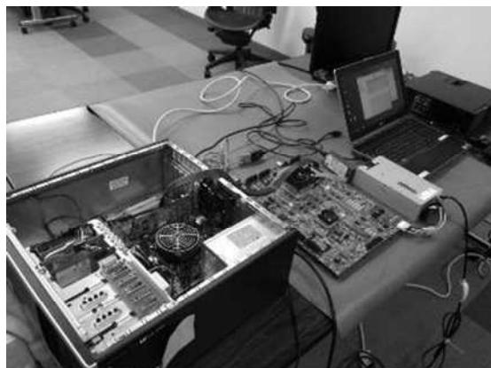
図III. 2.2.1-5 画像意味理解プロセッサ技術を実装した FPGA 搭載ボードを用いた評価環境
