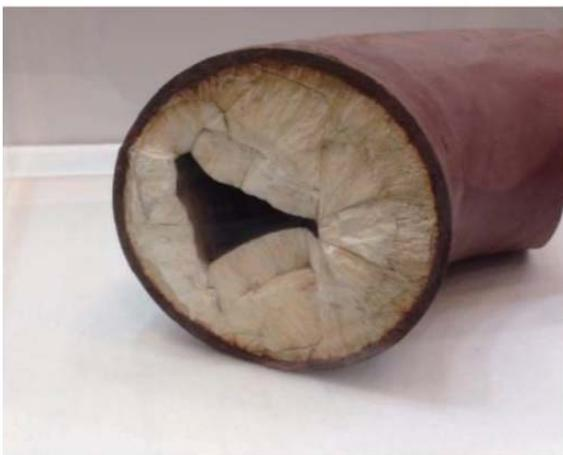
図26 スケールが付着した配管断面の例
