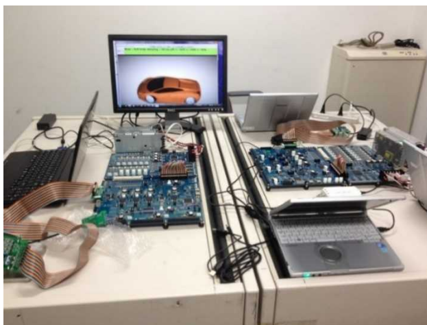
図 2.2-14 センサーノードシステム電力プロファイル評価環境-1
