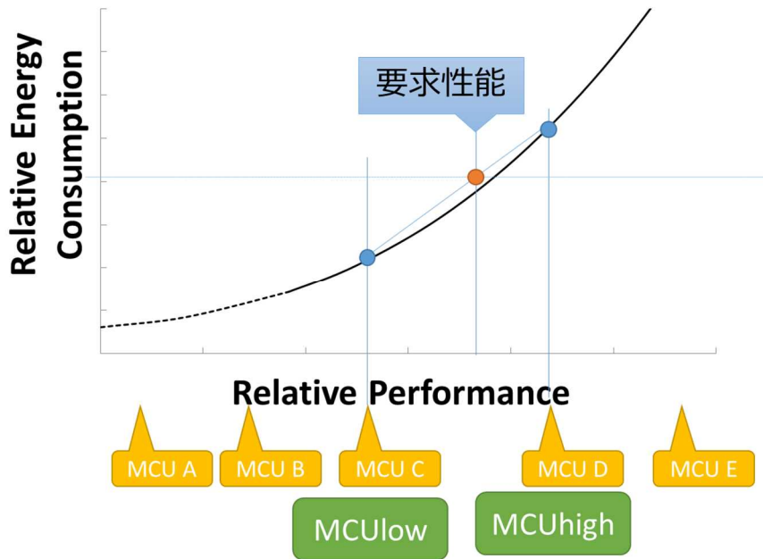
図 2.6-14 最適な MCU 構成
