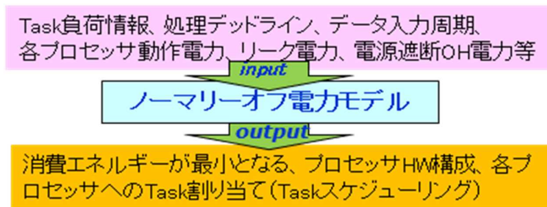
図 2.6-5 電力モデルを用いたタスクスケジューリング
