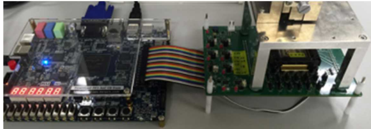
図 2.1-71 :4Mb-STT-MRAM キャッシュメモリとプロセッサチップの連動動作のデモ
