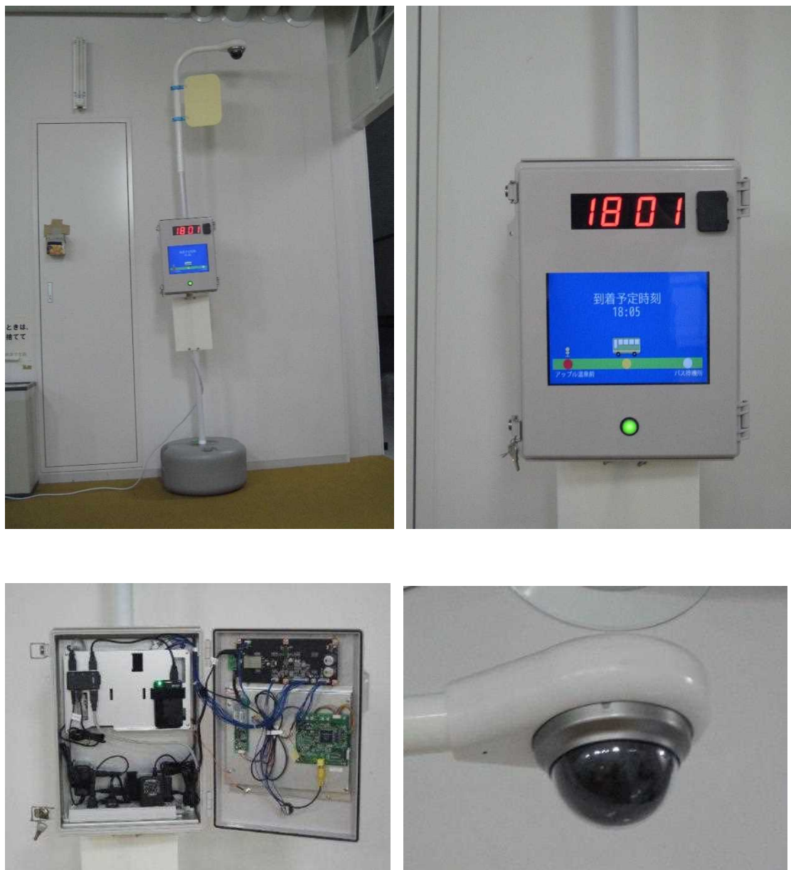
図 2. 2-26 知的バス停システムの外観(右上:全景、左上:表示部、右下:制御部、左下:天頂カメラ)
