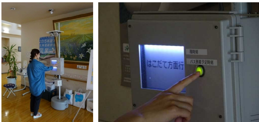
図 2. 2-36 新型知的バス停システムの外観と動作の様子
