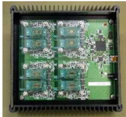
図 2.1-49 8 個の MTJ 素子を同時に測定し可能な反転確率測定器
