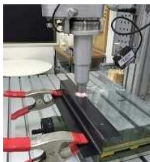
熱可塑複合材を用いて高いせん断強度を得るためには、接着に適した表面状態にする必要がある。表面処理として**大気圧プラズマ装置を用いた化学的**表面改質処理を選定した。
