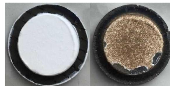
エロージョンスクリーニング試験後試験片外観 (MS)
