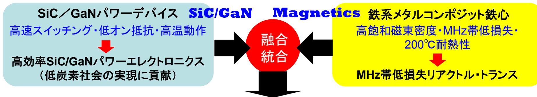
Siパワーデバイスでは実現が困難であったMHz帯スイッチングDC-DCコンバータ
