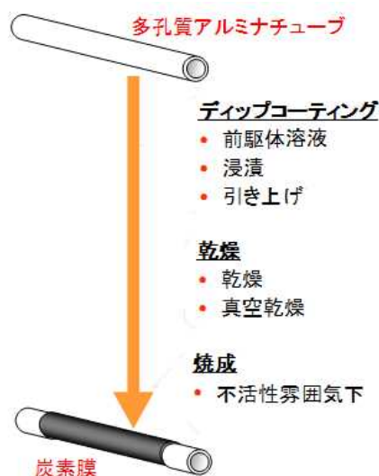
図Ⅲ.2.1.2-12 炭素膜の製膜手順
