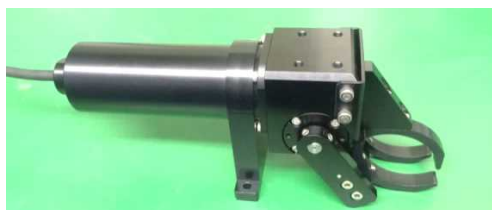
図Ⅲ-【③-(1)-7】-9 作業用アーム（簡易グリップ付） 図Ⅲ-【③-(1)-7】-10 回転駆動ユニット（清掃用ブラシ付）
