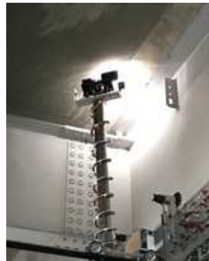
図Ⅲ-【③-(1)-3】-1 懸垂型ロボットの外観、およびカメラ昇降装置
