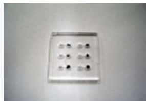
(a) 10mm 角石英基板を用いたガスセルの試作 (b) ガスセル内に封止した Cs
