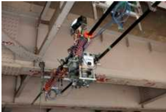
図Ⅲ-【③-(1)-3】-1 懸垂型ロボットの外観、およびカメラ昇降装置
