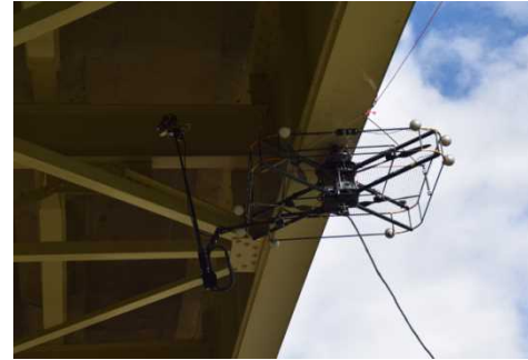
図Ⅲ-【③-(1)-1】-3 橋梁着脱型マルチコプタ
