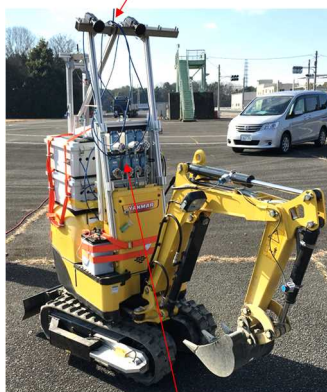
シリンダ駆動機構 (サーボモータで7自由度を制御)
