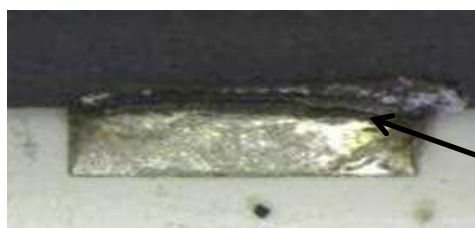
図Ⅲ-2-①-(2)-28 金属基板への大型面実装部品のヒートサイクル試験によるはんだクラックの発生
