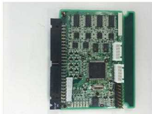
(b) 連系保護装置用制御基板写真
