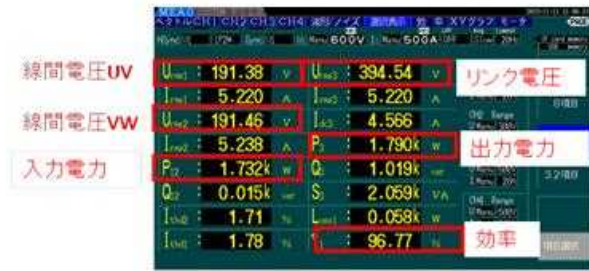
図Ⅲ-2-①-(2)-10 連系保護装置の入出力パラメータ
