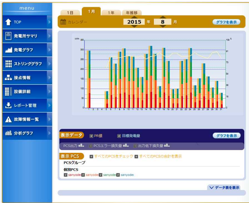
図Ⅲ-2-②-(1)-12 発電モニタ「月プロフィール」
