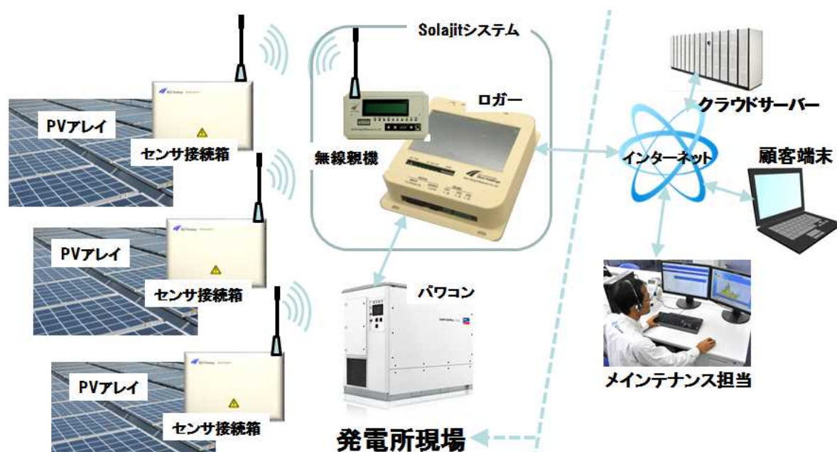
図Ⅲ-2-②-(1)-10 遠隔監視システム
