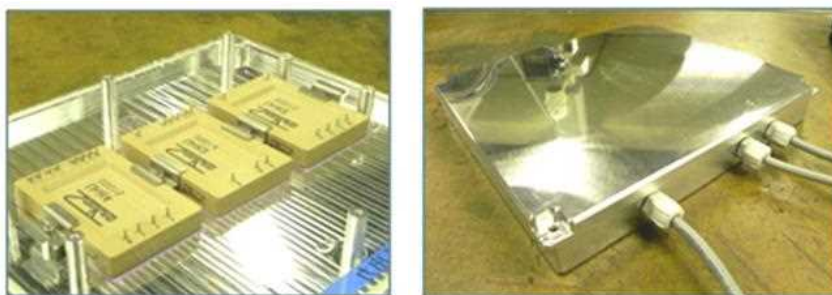
図Ⅲ-2-①-(2)-30 筐体気密評価用試作ユニット
