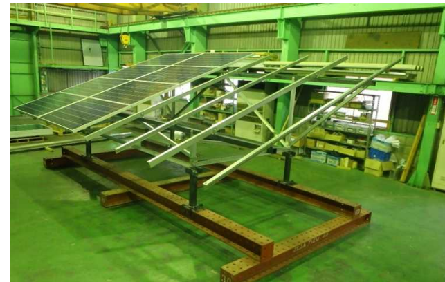
新架台(案)の施工検証1
