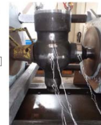
弁箱 耐圧試験 歪測定
