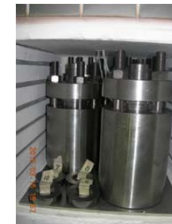
グラッドパッキン耐熱評価試験 720°C1200hr加熱 減重量
