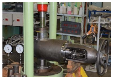
耐圧、弁座漏洩、作動試験
