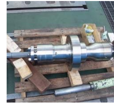
弁棒 (組込み後)
