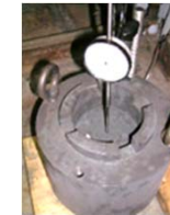
ボンネットパッキン 耐熱試験後の 水圧試験
