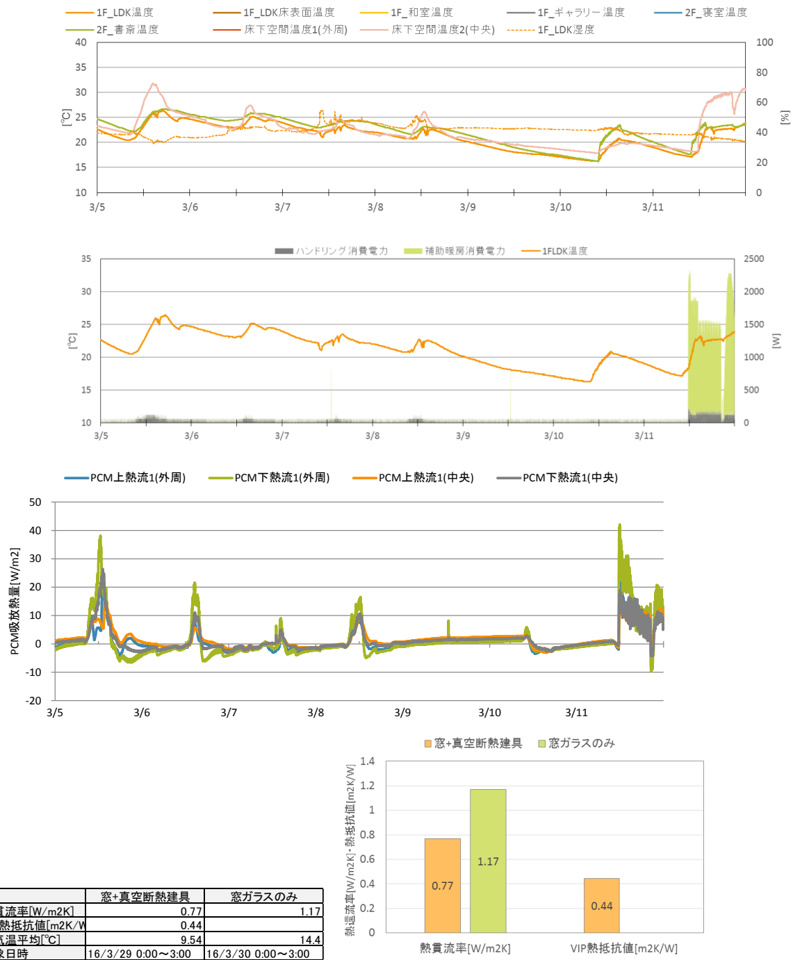
図 23 気象条件、集熱温度、室温、消費電力、PCM 吸放熱、真空断熱建具の結果 (2016 年 3 月 5 日～11 日)
