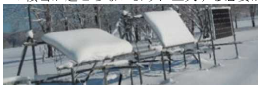
図Ⅲ-2-①-(3)-11 北海道 2016年1月16日13時の固定角度架台(気温マイナス8度)
