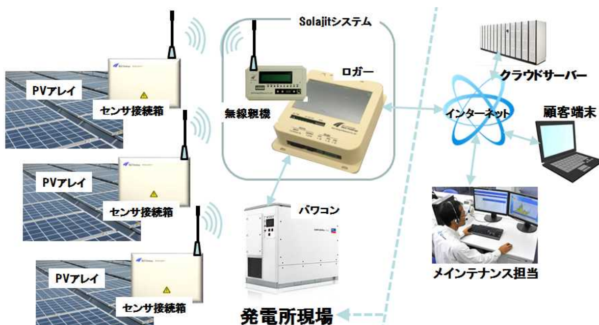
図Ⅲ-2-②-(1)-10 遠隔監視システム
