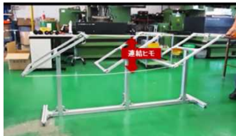
図Ⅲ-2-①-(3)-4 ミニサイズ可変架台試作機
