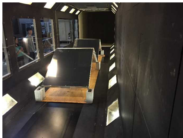
図Ⅲ-2-①-(4)-10 実物大モデルでの風洞実験
