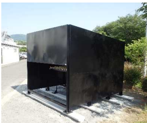
図Ⅲ-2-①-(6)-8 遮へい暴露試験台設置風景
