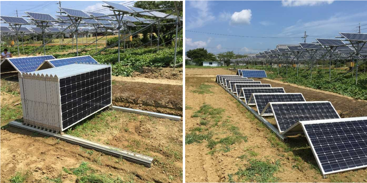
図Ⅲ-2-①-(4)-7 開発した折りたたみ架台
