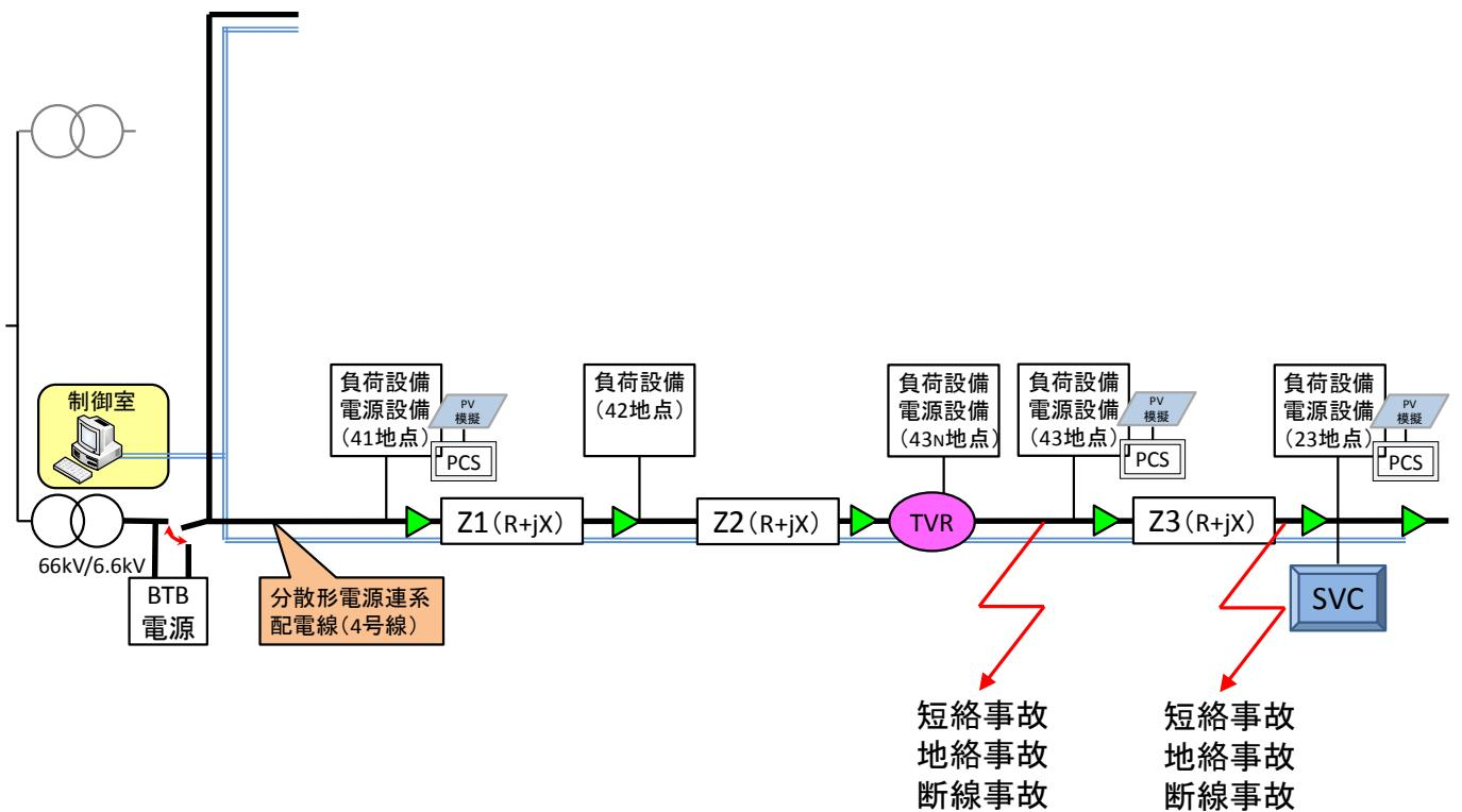
図 3-30 模擬グリッド(赤城)の試験回路(基本系統モデル[1回線])
