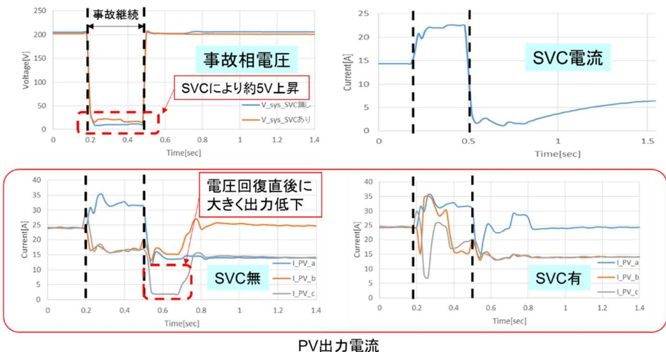
図 3-28 SVC による電圧抑制効果測定(例) 【試験パターン②】
