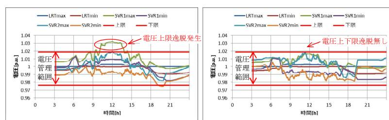
オフラインデジタルシミュレーションによる電圧維持性能比較
