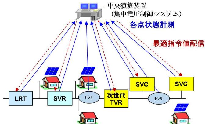
図3-1 集中電圧制御システム概念図
