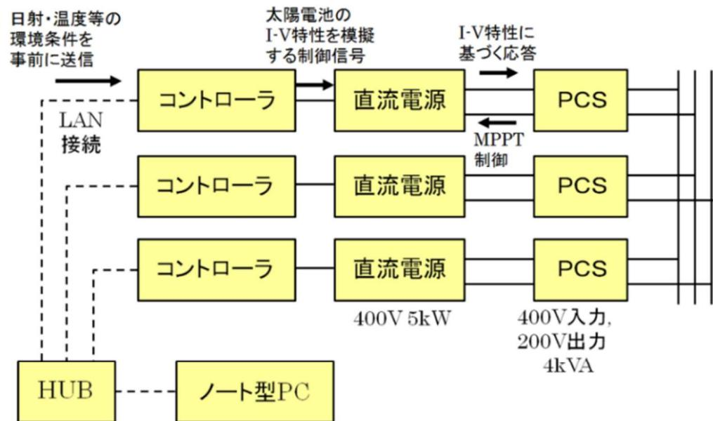
図 3-23 PV 模擬電源装置
