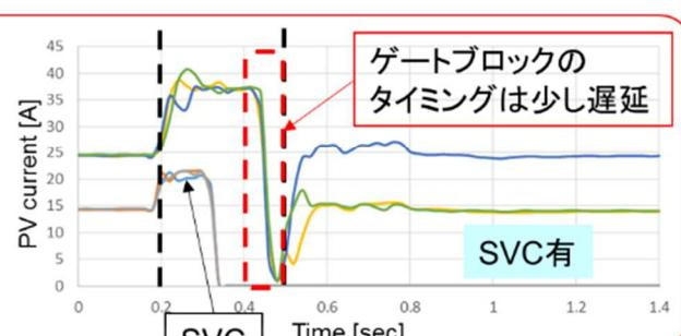
図 3-27 SVC による電圧抑制効果測定(例) 【試験パターン①】
