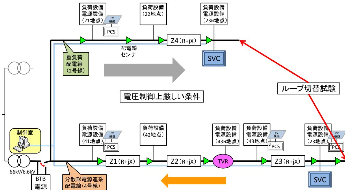
模擬グリッド(赤城)の試験回路(配電バンクモデル[2回線])
