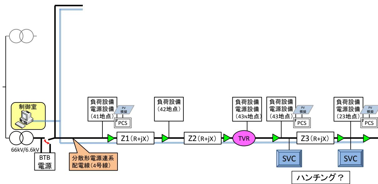
模擬グリッド(赤城)の試験回路(SVCハンチング検証モデル[1回線])
