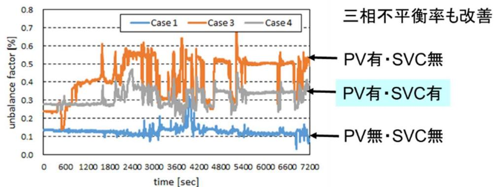
図 3-26 SVC による電圧抑制効果測定(例)
