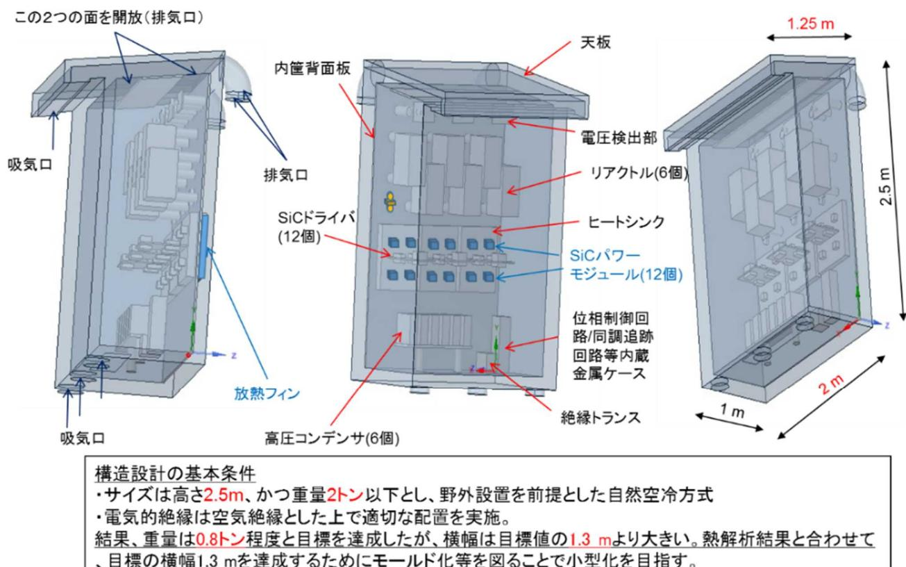
図 3-7 数値解析用 SVC 全体機器の内部構造図(空気絶縁タイプ)
