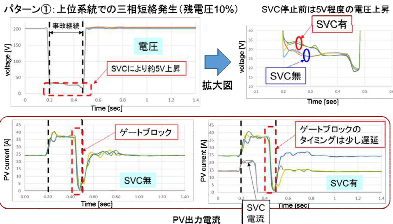
実験室グリッド(横国大)での機能試験データ例(例①)
