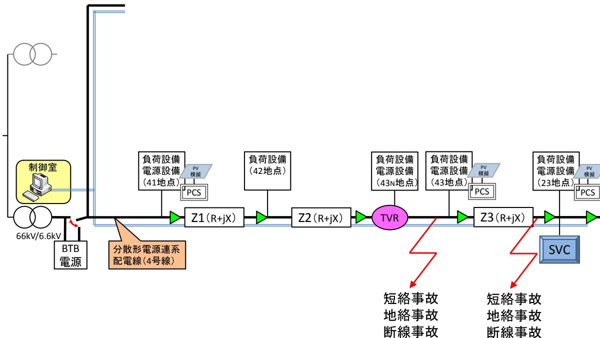
模擬グリッド(赤城)の試験回路(基本系統モデル[1回線])
