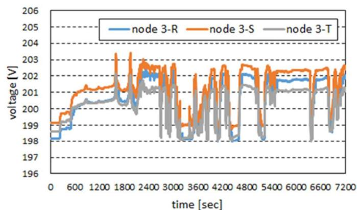
三相代表電圧を不感帯幅( $200\text{V} \pm 1\%$ )内に適切に制御
