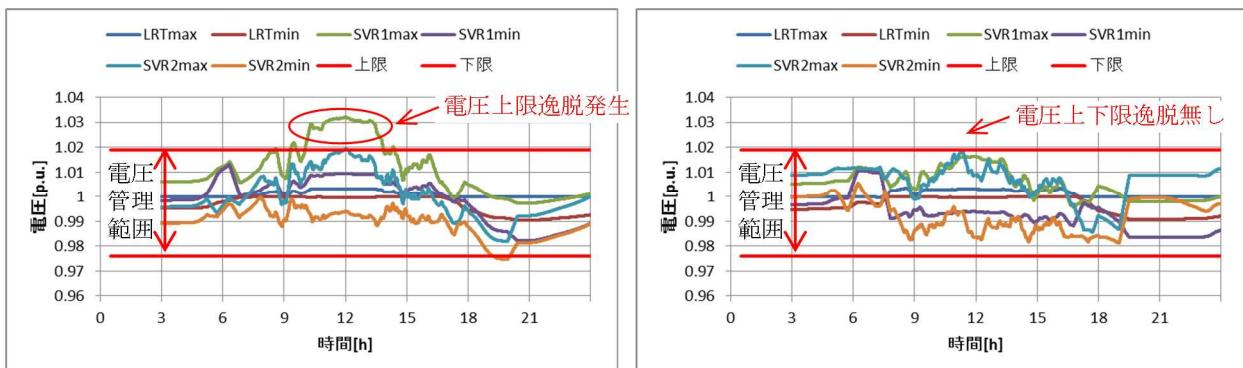
図3-2 オフラインデジタルシミュレーションによる電圧維持性能比較
