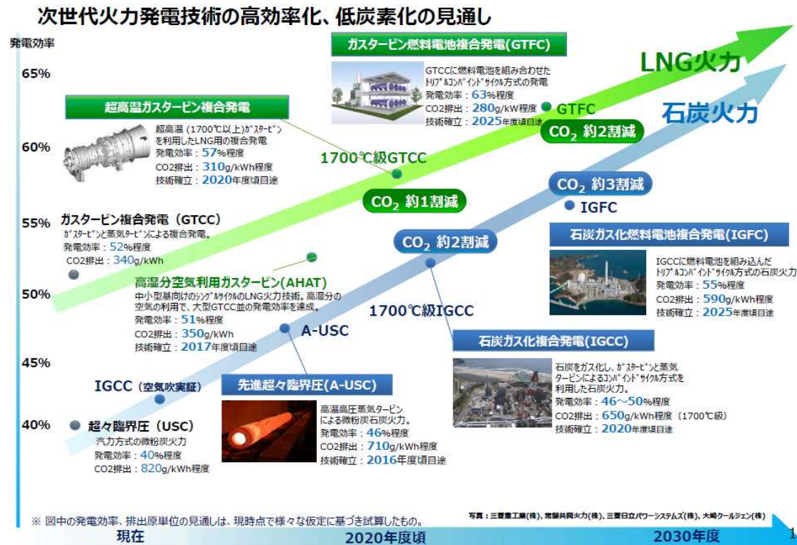
図 1-2 次世代火力発電に係る技術ロードマップ (次世代火力発電技術)
