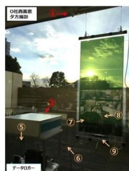
図 2.6-16-1 窓周りへのモジュール設置検討
