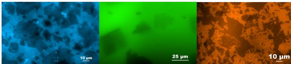
図 2.5.1-4 色素として、(左) H33342、(中) フルオレセイン、(右) ローダミン b を用いたグラフェン水分散液の顕微鏡像.
