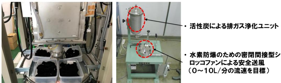
図 2.6-22-1 開発した単層 CNT 合成装置
