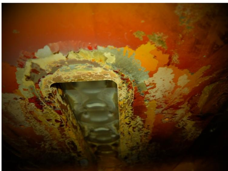
図2. 4. 1-14 GR1000型機の成膜室に装備したマイクロ波ランチャーの石英窓
