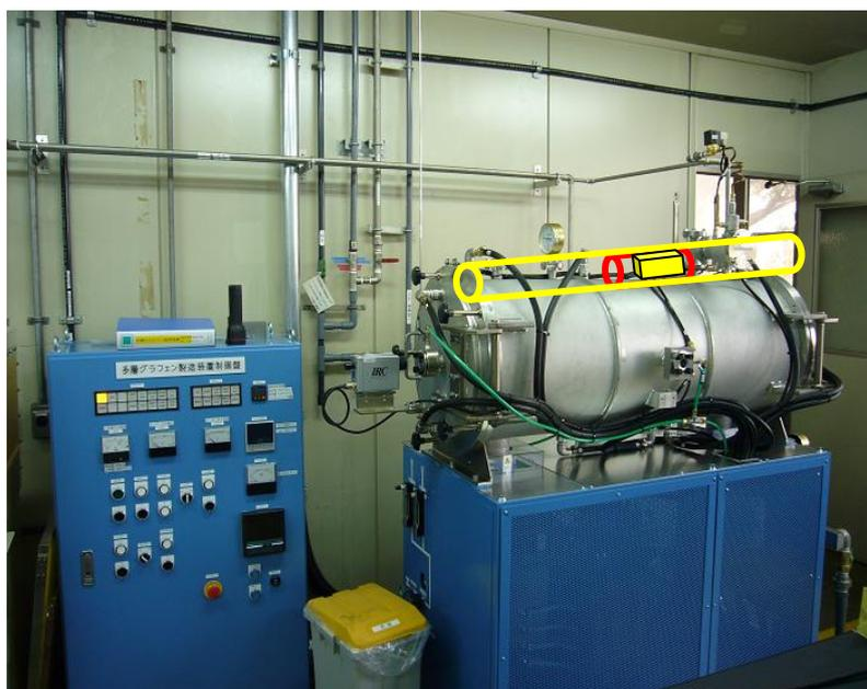
図2. 4. 2-44 超高温（3200°C）での熱処理が可能なタンマン炉
