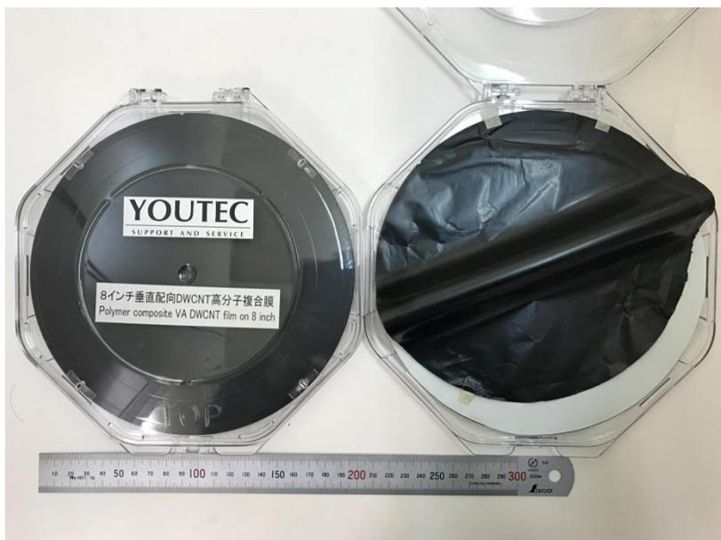
図 2.6.12-4  $\Phi 8\text{inch}$  フレキシブル垂直成長 DWCNT 高分子複合膜
