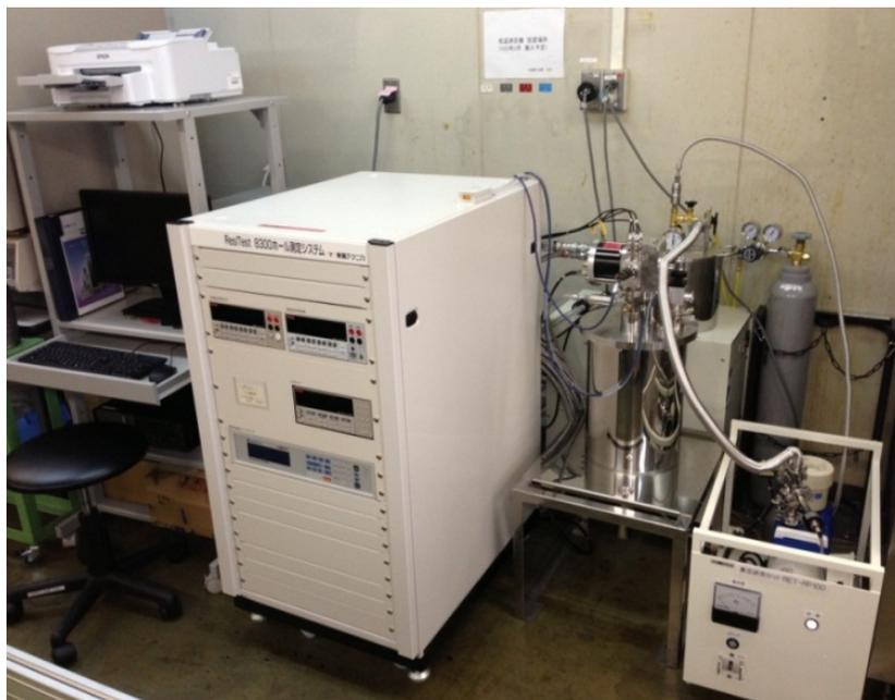
図2. 4. 2-56 低温電気物性測定装置
