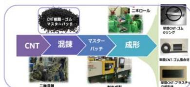
図3 CNT複合材料研究拠点での製造プロセスの流れ
