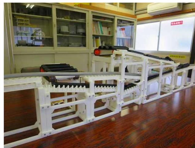
図3-25 高速船上防護管取付工法パ斯拉インの1/10モデル(3Dプリンタ模型)
