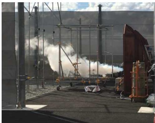
液化水素漏洩拡散実験の様子
