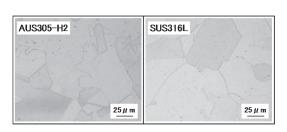
図33 ミクロ組織の例(固溶化熱処理材)
