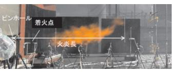
(a)液化水素漏洩拡散試験
