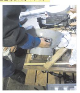
図1 超音波探傷検査
