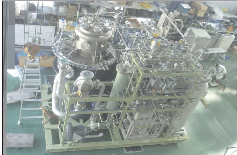
図 14 水素製造装置 ( 実証試験装置 )
