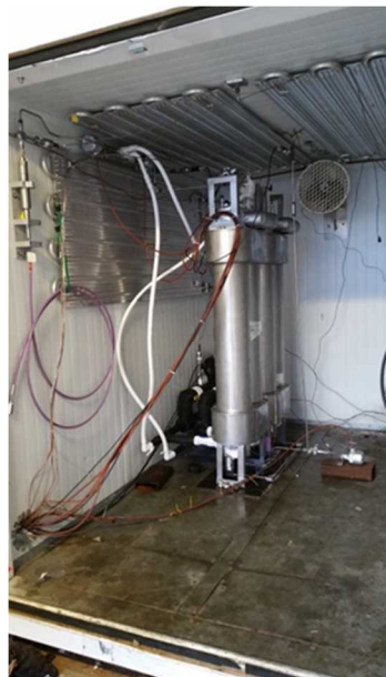
図9 Powertech Labs Inc.急速充填試験設備
