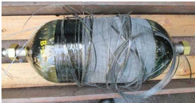
Fig. 3 厚肉ライナ (9.4 L 容器): 破裂圧力 (86 MPa)
