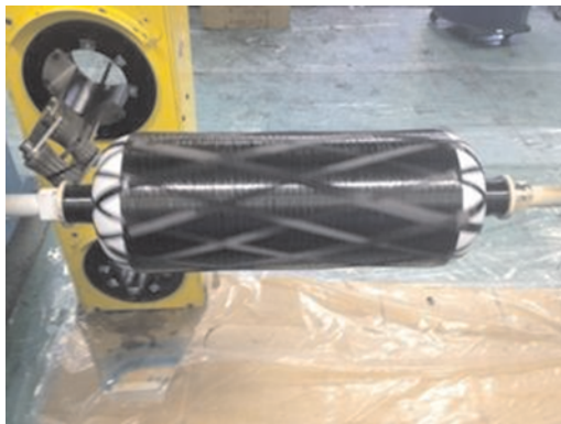
図10 新TPP-C 7.5L容器 破裂試験後
