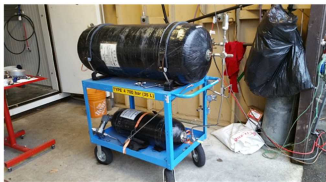
図9 Powertech Labs Inc.急速充填試験設備
