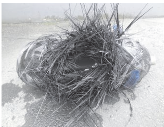
図11 新TPP-C 7.5L容器 破裂試験後
