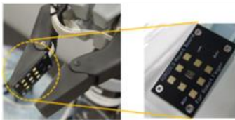
①48個バスネットワーク接続, イベントドリブン動作の実証
