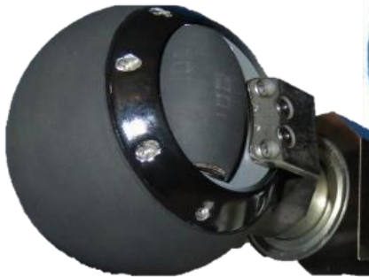
外部支持方式の球状全方向車輪
