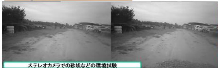
ステレオカメラでの砂埃などの環境試験
