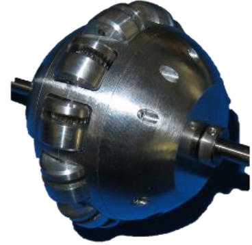
スクリー式回転差動機構による全方向駆動車輪
