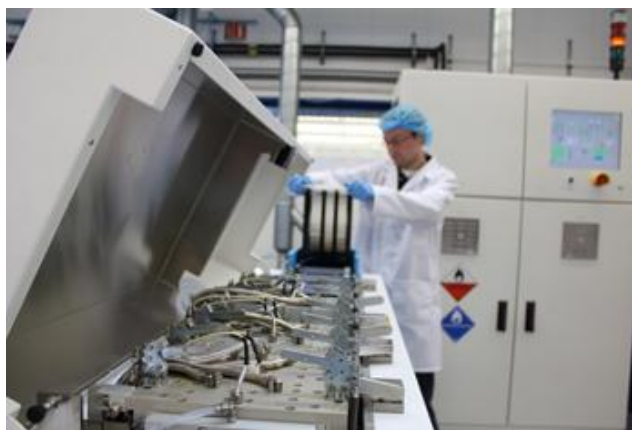
空間 ALD \text{Al}_2\text{O}_3 を蒸着させるための SoLayTec 社の InPassion LAB(PDT)ツール
