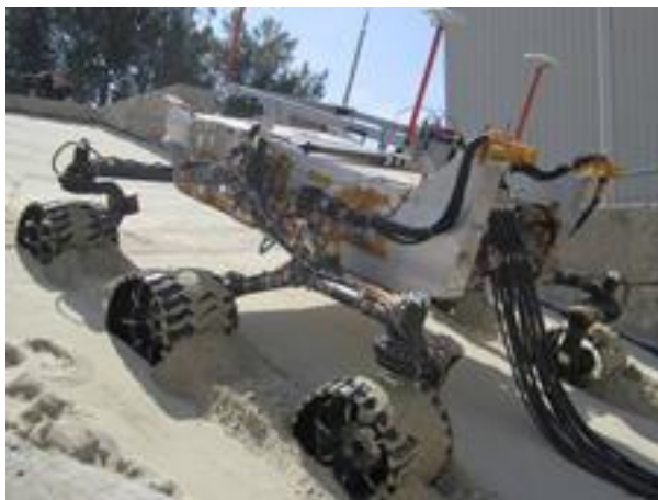
ジェット推進研究所(JPL)の砂だらけの Mars Yard に置かれた、NASA の火星科学研究所(Mars Science Laboratory:MSL)の設計/試験モデル(DTM)
