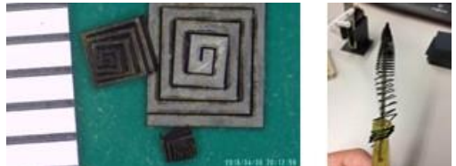
図Ⅲ2-4-1-1-11 フェムト秒レーザーによるCFRPの加工(バネ加工例)
