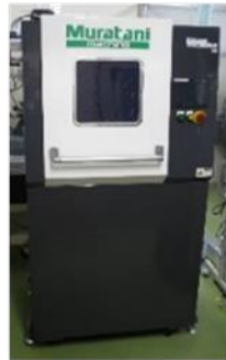
青色半導体レーザー搭載型の加工装置 （左 3Dプリンタ、右 熱伝導溶接機）
