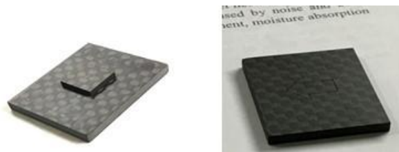
図Ⅲ2-4-1-1-13 高品位深紫外レーザーによるCFRPの加工(加工部を押し出した写真(a)と平らにした写真(b))
