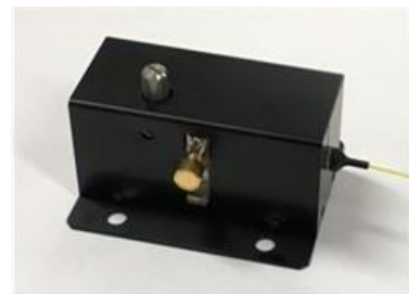
図Ⅲ2-4-1-1-4 外部共振器構造による長光子寿命半導体レーザー発振器モジュールのプロトタイプ
