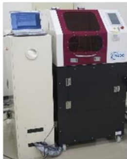
青色半導体レーザー搭載型の加工装置 （左 3Dプリンタ、右 熱伝導溶接機）
