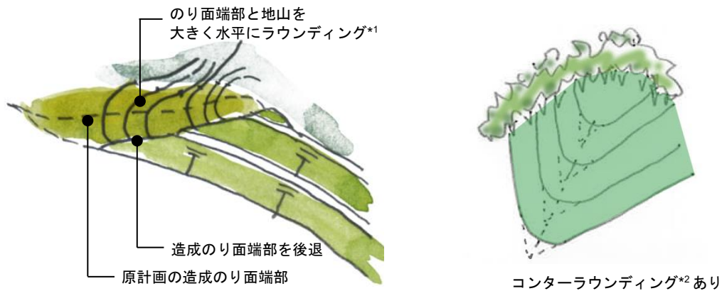
図 5.10 コンターラウンディングを施したのり面*2
