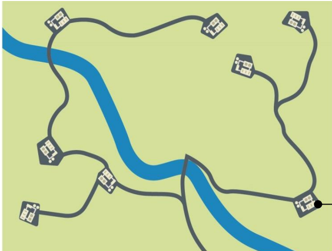
図 5.178 大きな発電施設が不要な坑口発電
