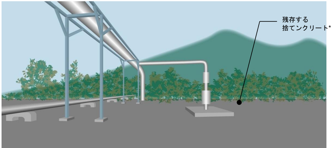
図 5.101 捨てコンクリート*をした一般的な坑井基地
