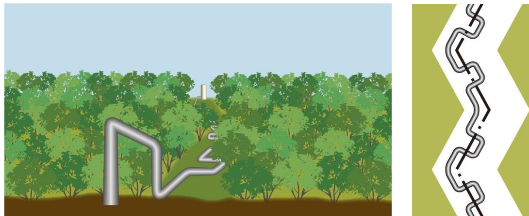
図 5.134 蛇行させたパイプライン
