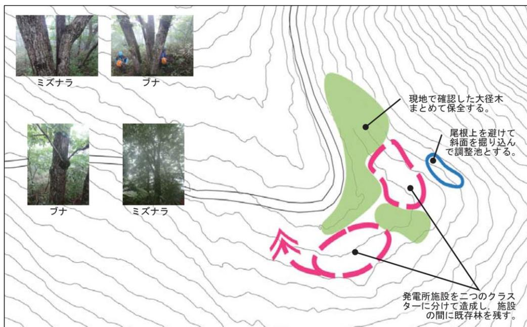
図 6.2.1 開発計画方針図例<sup>27</sup>
