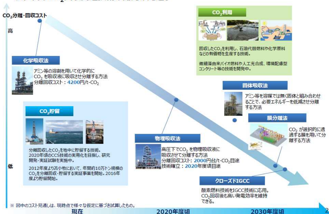
図 1-3 次世代火力発電に係る技術ロードマップ (CO 2 回収関連技術)
