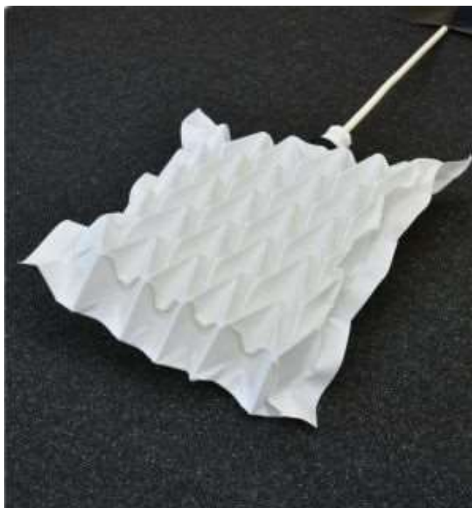
人工筋肉スケルトンの構造ジオメトリが、筋肉の動きを決定する。Credit: Shuguang Li / Wyss Institute at Harvard University / MIT CSAIL
