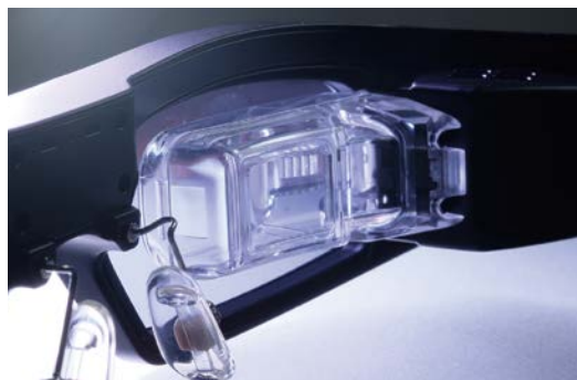
3色のレーザー光を複数のミラーを経て、 瞳孔に入れる光学系。
