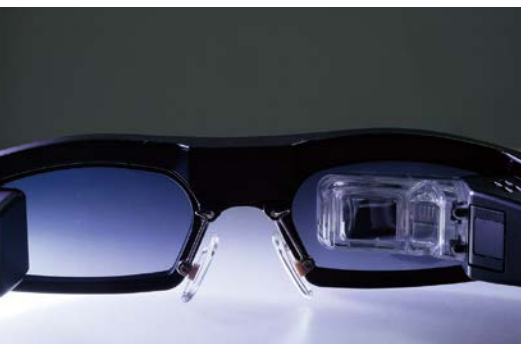
「RETISSA (レティッサ)」の内側。 右目部分の装置から投影される
