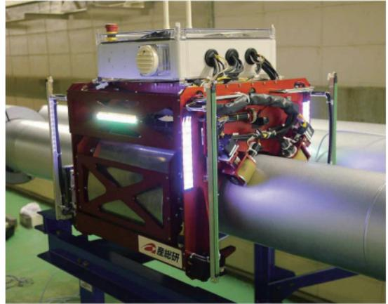
図12. エックス線管厚計搭載自走ロボット（夜間運用）
