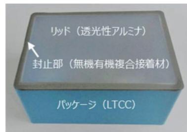
図 6 封止したセンサ端末パッケージ
