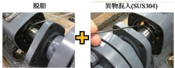
写真2 軸受の模擬損傷
