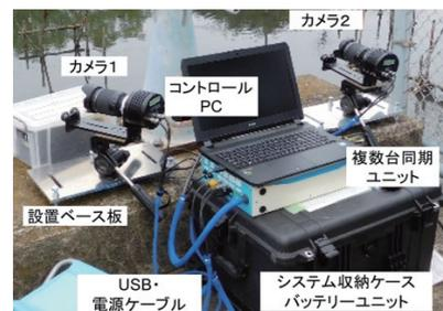
図8 開発した一般土木用変位計測システム
