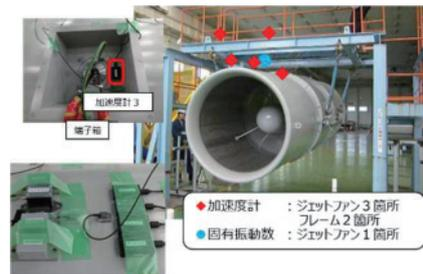
図 75 センサ端末単体基礎実験
