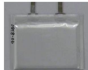
図 12 作成した二次電池外観
