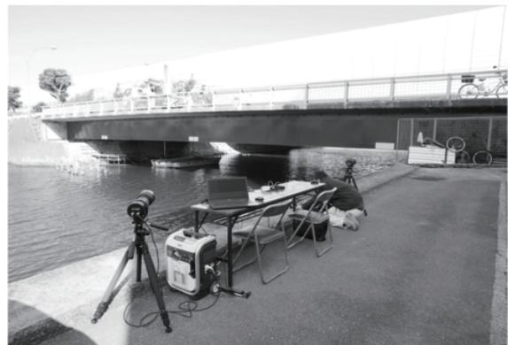
図3. 鋼橋でのたわみ測定例
