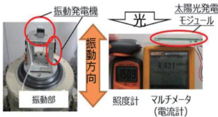
図 10 発電モジュール評価機器構成
