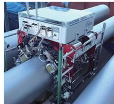
図 10. 中性子水分計搭載自走ロボット
