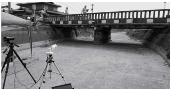
図5 コンクリート橋の多点変位測定例
