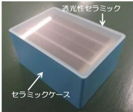
図7 傾斜マルチセンサ端末の外観写真
