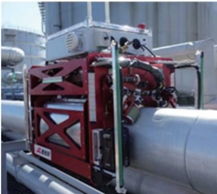
図11. エックス線管厚計搭載自走ロボット
