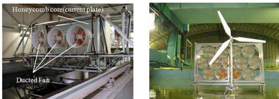
図 3.2-3 仮設送風装置の例
