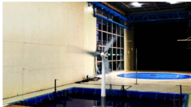
図 3.3-3 浮体風車試験の状況 27
