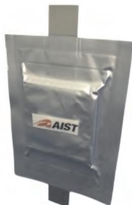
図 3.2-2-7 コンバージョン電池 実セルの外観
