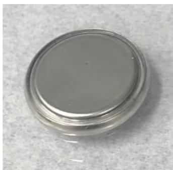
図 3.2-2-1 ハロゲン化物電池
