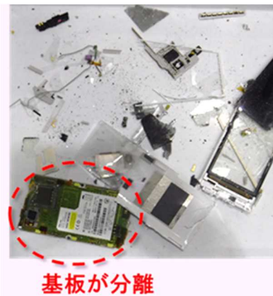
図 3.1.2.4 筐体破壊試験結果の例
