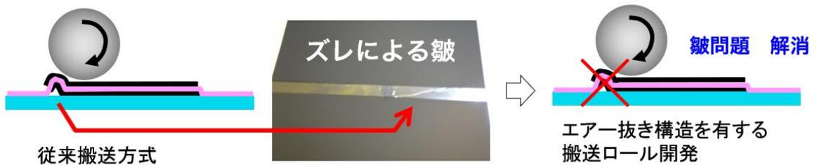
b) CCM とサブガスケットフィルムの接合（貼付）を短時間でシワなく実施する技術の確立
