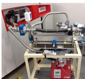
(左図)硫黄種の電位依存吸着構造を決定するための表面 X 線散乱測定システム。
