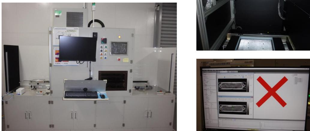
図 16. 欠陥検出自動機
