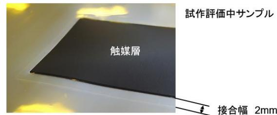
また、CCM とサブガスケットフィルムの接合においては、下図に示す様にそれぞれの位置をセル毎に画像検知・補正しながら連続処理を行う技術を開発。
