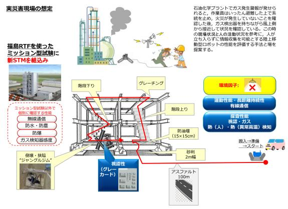
図 Ⅲ2.1.1.5-4 プラント災害を想定したミッション型試験の考え方
