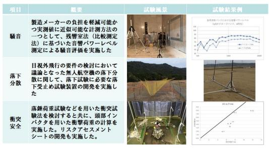
図Ⅲ2.1.1.6-19 騒音評価、落下試験評価、対人衝突安全評価の試験手法の開発成果
