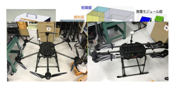
図Ⅲ2.1.2-13 コンパクトハイパワー燃料電池システムの外観と構成
