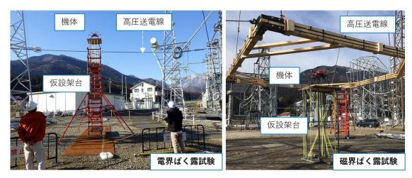
図Ⅲ2.1.1.1-21 電磁界ばく露検証試験の様子
