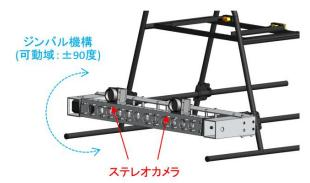
図Ⅲ2.2.2.1-12 カメラジンバル CAD 図とその可動範囲
