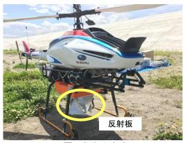
図Ⅲ2.2.1.3-8 脅威機に取り付けた反射板
