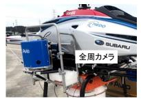
図Ⅲ2.2.1.3-10 探知機への光波センサの搭載状況
