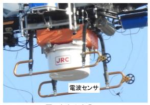
図Ⅲ2.2.1.3-7 探知機への電波センサの搭載状況
