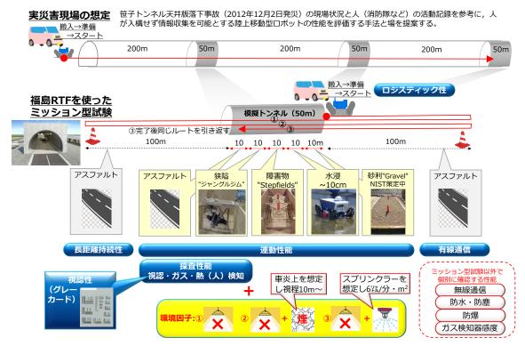
図 Ⅲ2.1.1.5-3 トンネル災害を想定したミッション型試験の考え方
