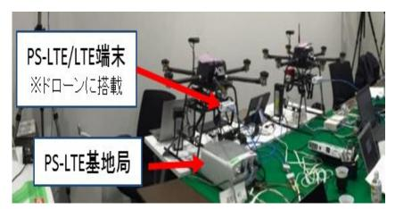
図皿2.2.1.1-11 PS-LTE/LTE マルチ接続通信環境
