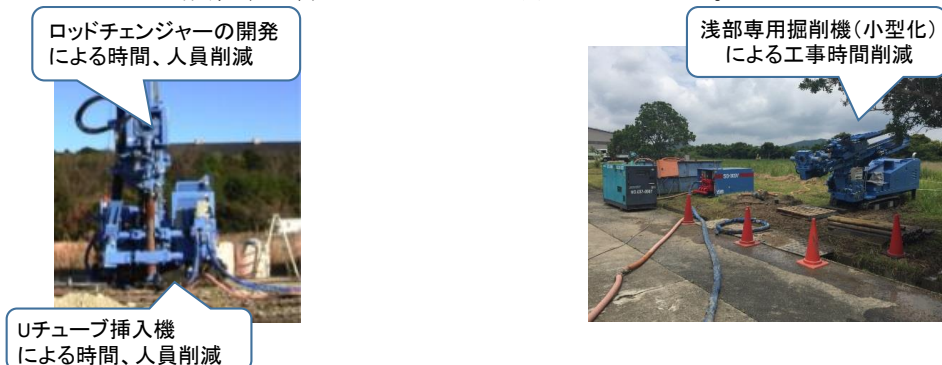
図Ⅲ(1.3)-1 開発した掘削機
